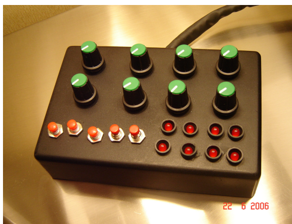
Figura 3 Simulador de sensores e atuadores.
